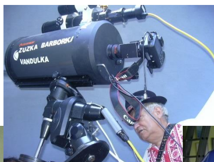
Hlavní dalekohled hvězdárny pointovaný systémem Lacerta.
