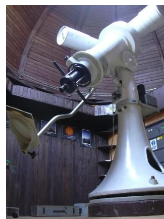
Klasický Coudé refraktor je výborný dalekohled pro pozorování Slunce.
