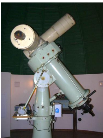
Renovovaný Coudé refraktor Zeiss 150/2250mm
