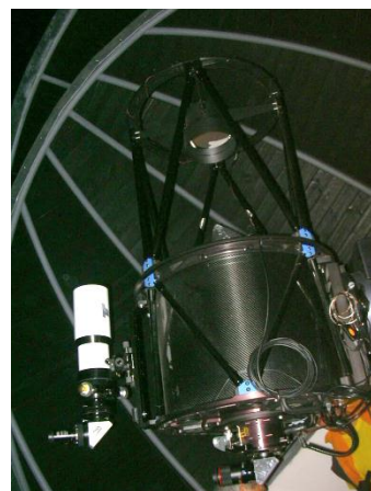
Nový moderní astrograf 500/3454mm (černý dalekohled se v černé kopuli za tmy tmoucí dost špatně fotí)
