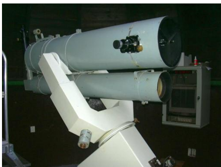
Hlavní teleskopy hvězdárny – Newton 300/1580 a refraktor Carl Zeiss Jena 150/2250
