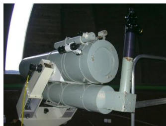
Hlavní teleskopy hvězdárny – Newton 300/1580 a refraktor Carl Zeiss Jena 150/2250
