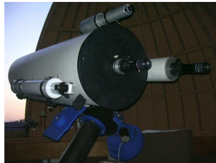
kombinovaný Newton a Cassegrain 450/6750 refraktor 150/2200 chromosférický a fotosférický dalekohled
