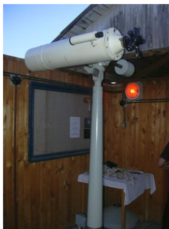
Dalekohled o průměru 150 mm a nedokončená montáž v sousední pozorovatelně
