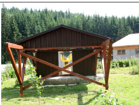
Reflektor 317/1500 s odsuvnou strechou
