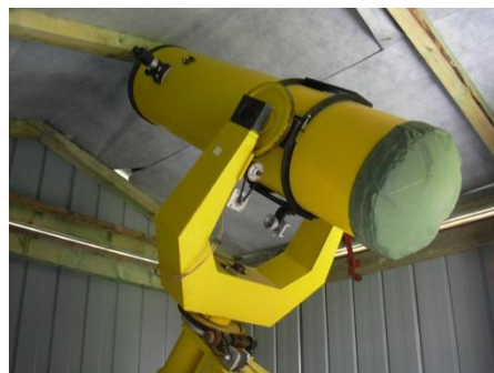
Menší Newton v domečku s odsuvnou střechou
