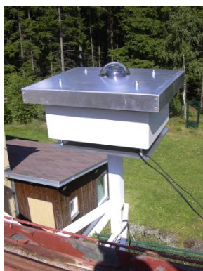
Moderní celooblohová komora typu „rybí oko“
