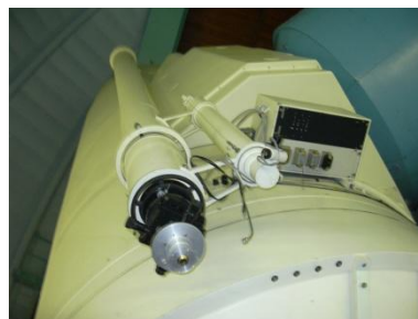
Náš největší reflektor i refraktor na společné montáži
